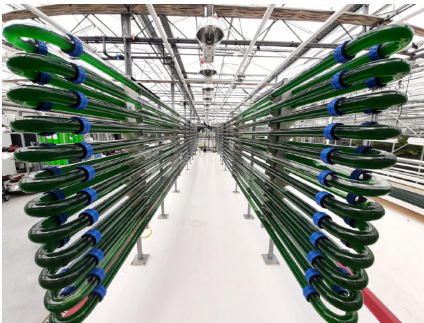
Рис. 2.2. Проточные трубные биореакторы для культивирования микроводорослей [12]
