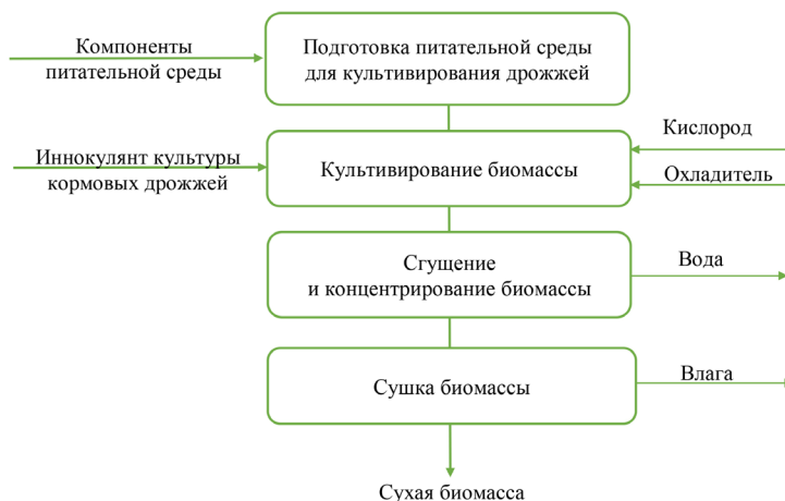
Рис. 2.3. Процессуальная схема получения белковых кормовых дрожжей
