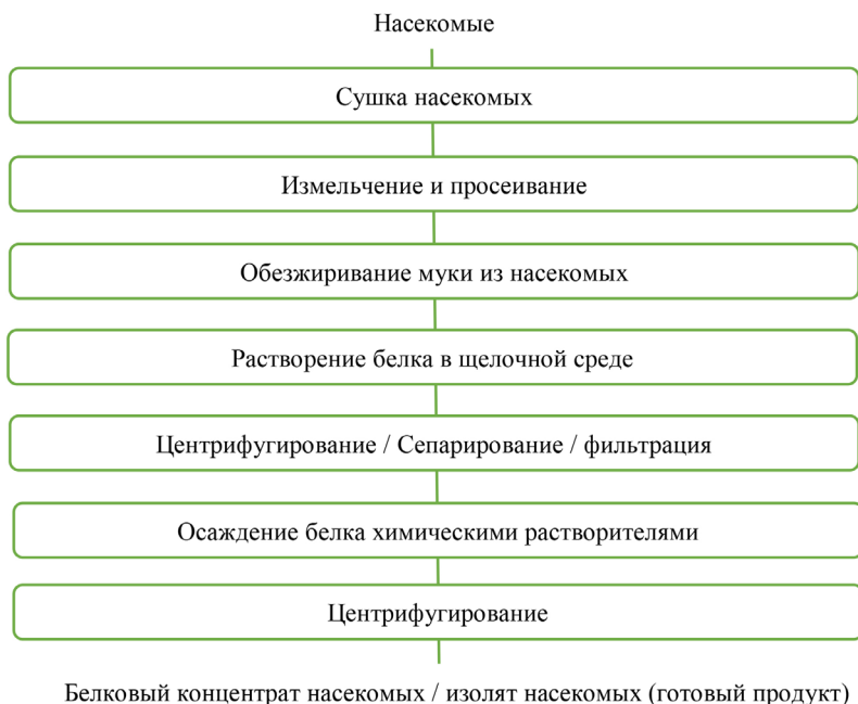
Рис. 4.1. Процессуальная схема получения белка из насекомых
